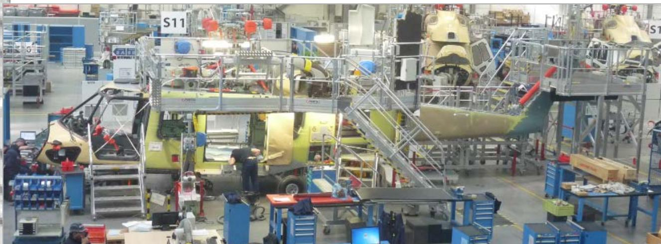
Praticable latéral gauche/droite livré clé en main avec protections, signalisation, équipement électrique et air comprimé :
