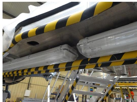
Mousse de protection autocollante sur les parties avec risque de contact opérateur
