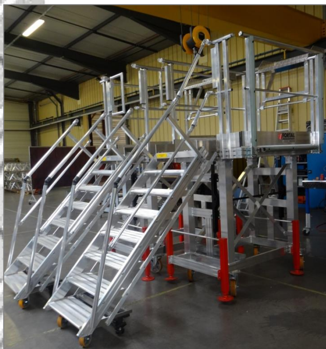
Système à crémaillère pour réglage en hauteur de la plate forme
