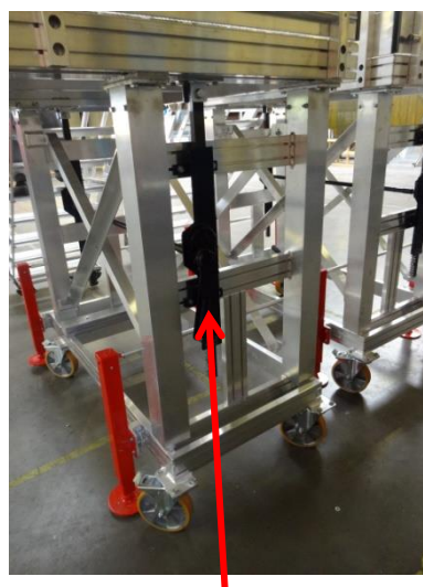
Système à crémaillère pour réglage en hauteur de la plate forme
