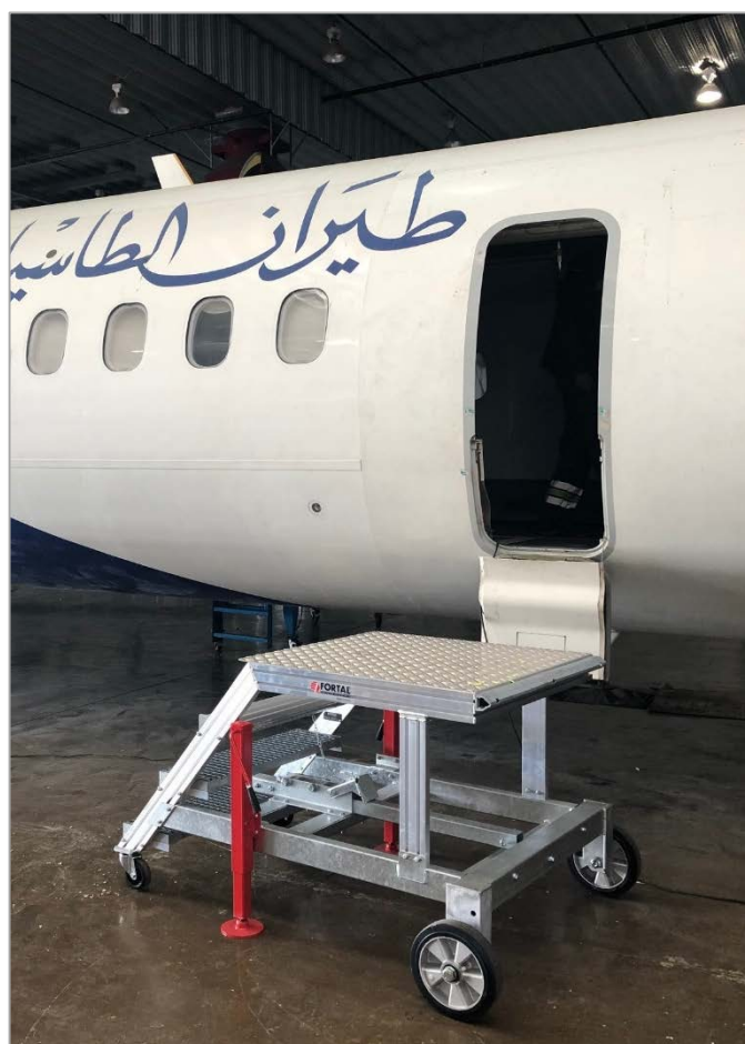
Escabeau 8 marches – palier standard – garde-corps coulissants – rampes en aluminium avec main courante et sous lisse – marches en aluminium strié antidérapant prof. 261 mm – charge maxi. 1 personne + outillage soit 165 kg.
