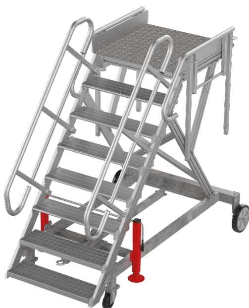
Escabeau 8 marches – palier standard – garde-corps coulissants – rampes en aluminium avec main courante et sous lisse – marches en aluminium strié antidérapant prof. 261 mm – charge maxi. 1 personne + outillage soit 165 kg.
