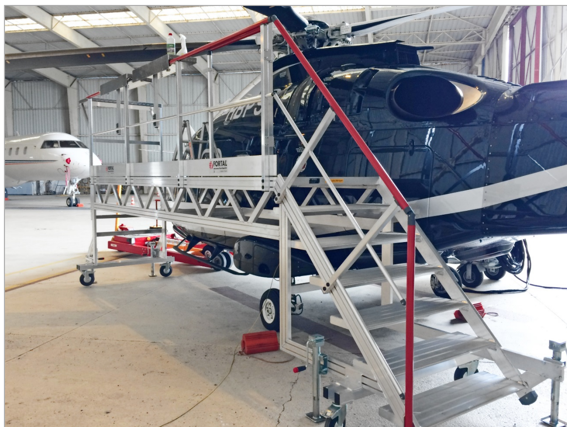
Plateforme équipée de 3 tablettes porte-outils amovibles en tôle alu larmée.
