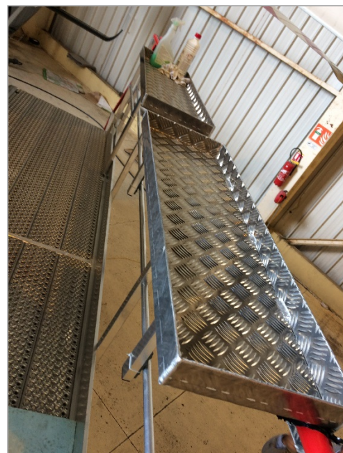
Plateforme équipée de 3 tablettes porte-outils amovibles en tôle alu larmée.
