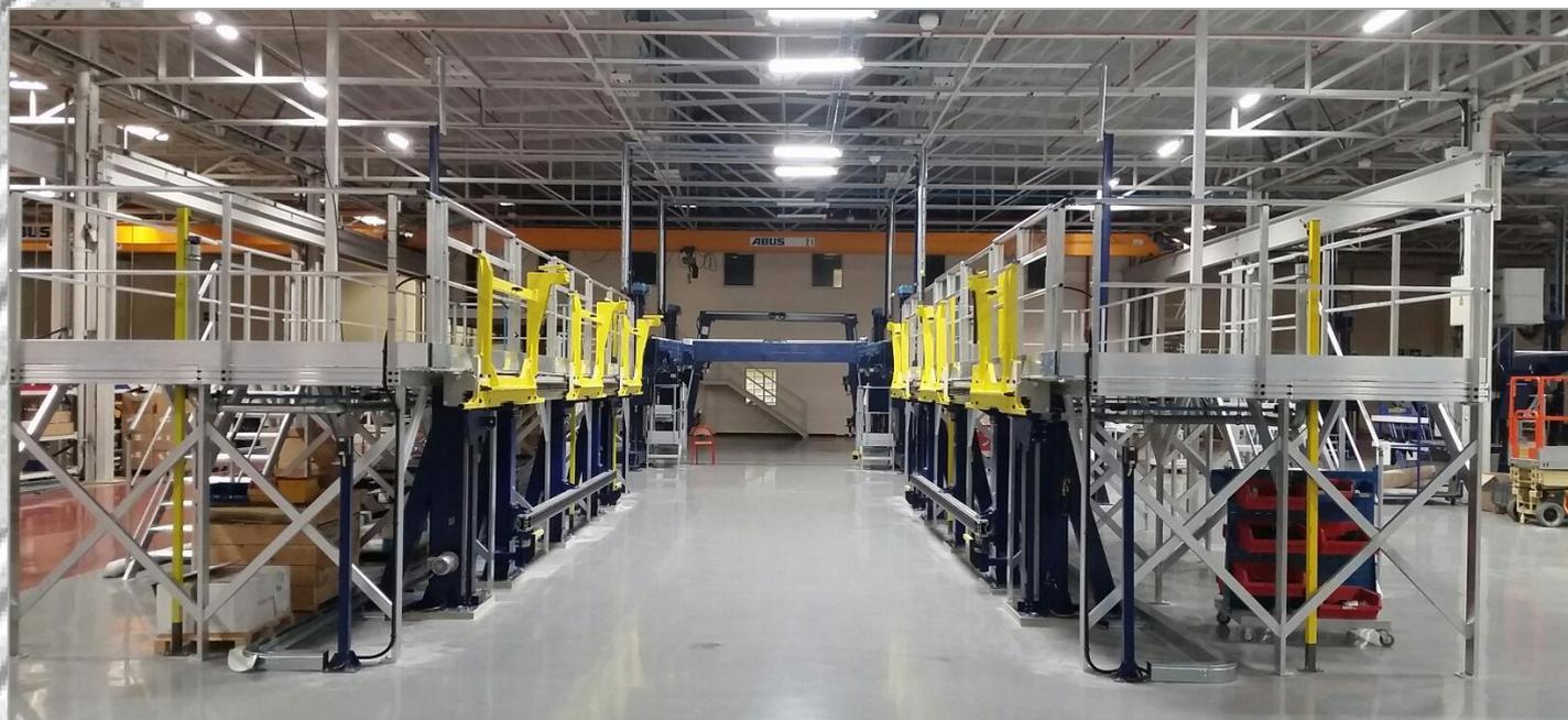
Passerelle aluminium symétrique 11 900 x 2 600 mm
