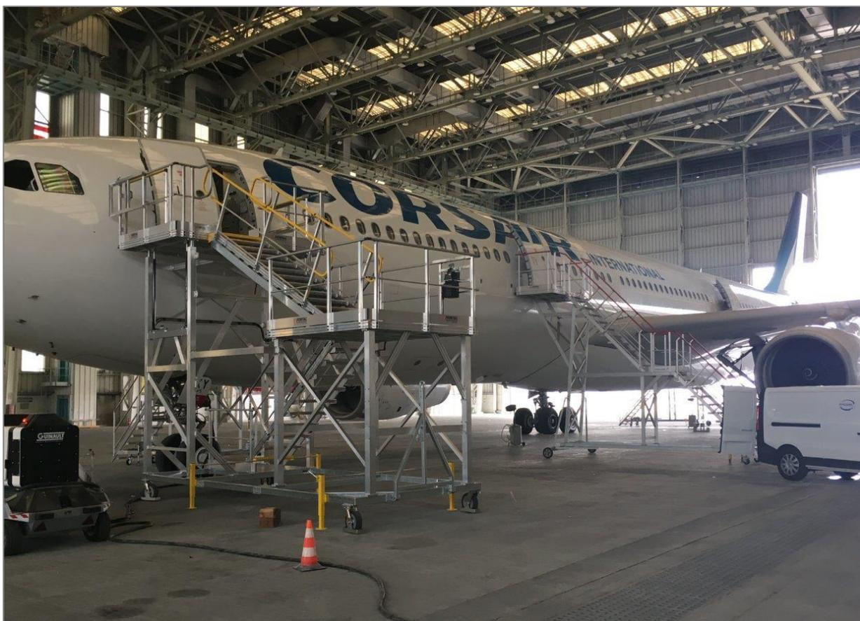
Plateforme : structure aluminium montée sur châssis acier galvanisé
