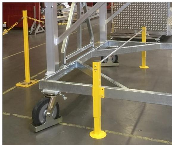
Déplacement de la plateforme par 4 roues pivotantes indexables sans frein avec protège pieds Ø 300 mm
