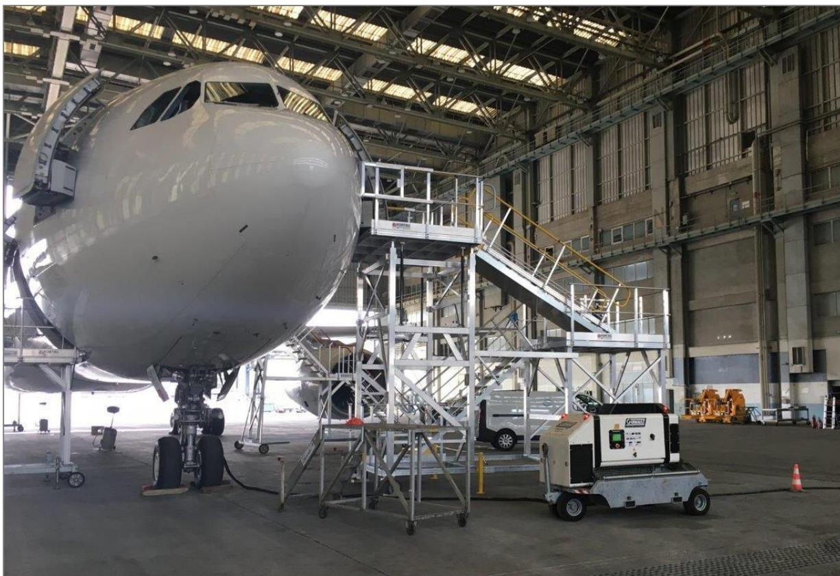
Plateforme réglable en hauteur de 4 000 à 5 600 mm à l'aide de 4 vérins hydrauliques et d'une pompe à main actionnable depuis le 1<sup>er</sup> niveau
