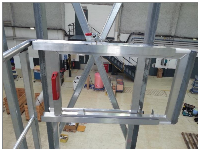
Garde-corps coulissant pour s'approcher au plus près de la voilure
