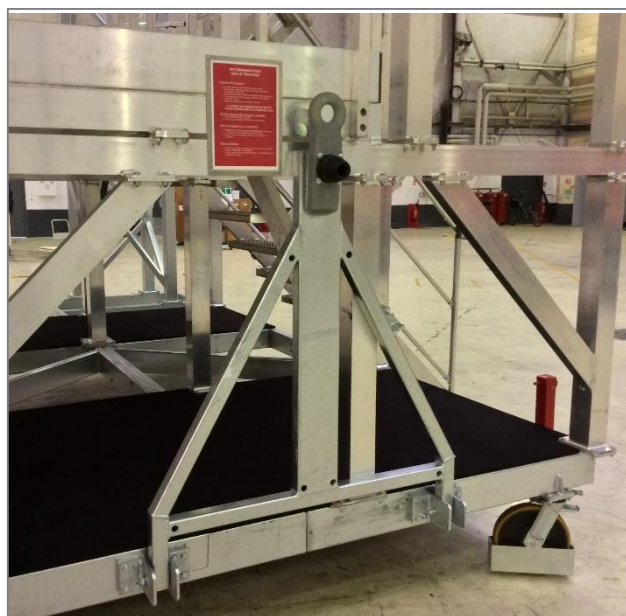
Timon de tractage blocable muni d'un support antivibratoire - en position relevée – vitesse maxi de tractage : 5 km/h
