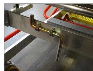
Marche arrière escamotable par commande manuelle Protection antichocs non tachante
