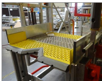
Marche arrière escamotable par commande manuelle Protection antichocs non tachante
