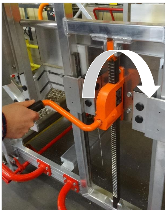
Garde-corps latéraux coulissants vers le bas par mécanisme sur crémaillère
