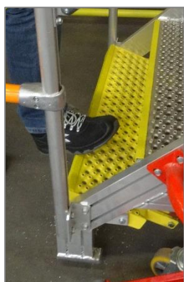
Garde-corps latéraux coulissants vers le bas par mécanisme sur crémaillère
