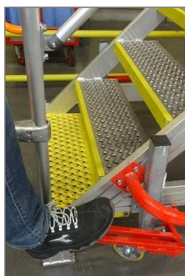
Garde-corps latéraux coulissants vers le bas par mécanisme sur crémaillère
