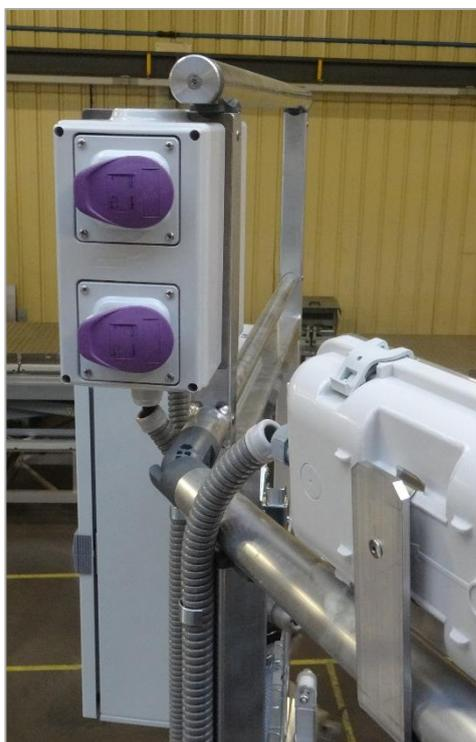
Equipement électrique avec câblage sous gaine de protection métallique
