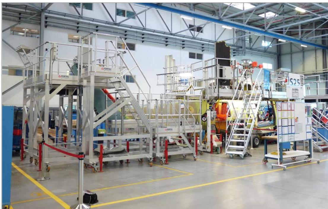
Accès par escalier à angle variable avec roulettes fixes Ø 100 mm en partie basse et demi portillon à retour automatique en haut
