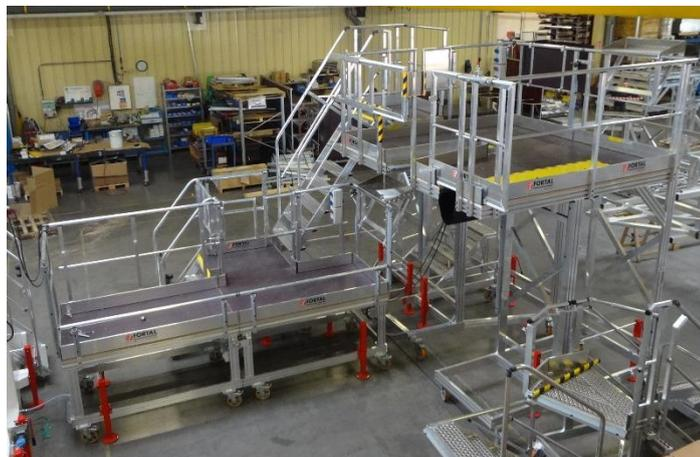
Praticable pylône avec système d'attache rapide sans outils au praticable poutre de queue
