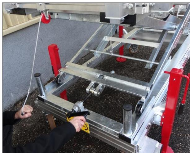
Ajustement de la hauteur par une seule personne par manivelle – déverrouillage de la sécurité par simple poignée
