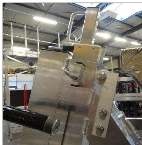
Vue sur le mécanisme de déploiement de l'échelle à marches avec loquet à ressort pour blocage en position déployée
