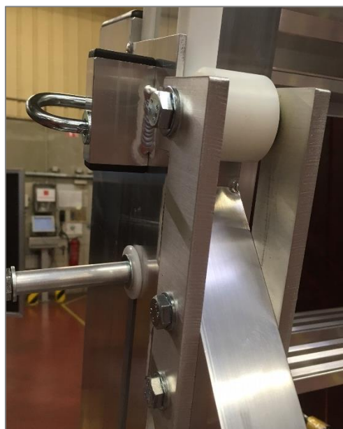
Vue sur le mécanisme de déploiement de l'échelle à marches avec loquet à ressort pour blocage en position déployée
