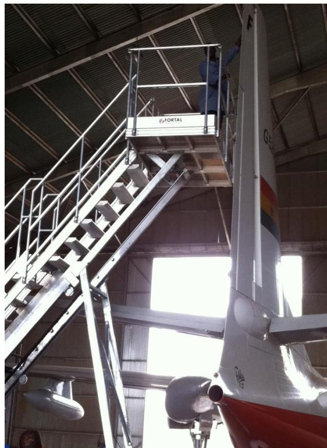
Plate forme réglable en hauteur de 1,75 à 5 mètres pour usages multiples avec système hydraulique.
