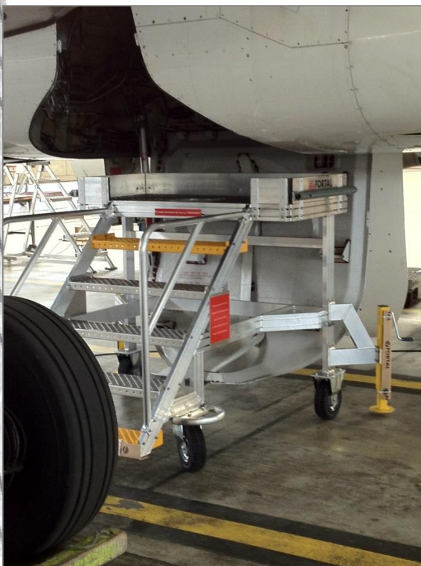
Airbus A319 : escabeau pour accès puits de train d'atterrissage
